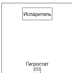
Рисунок 5: Место установки датчика влажности/комбинированного датчика скамьи
